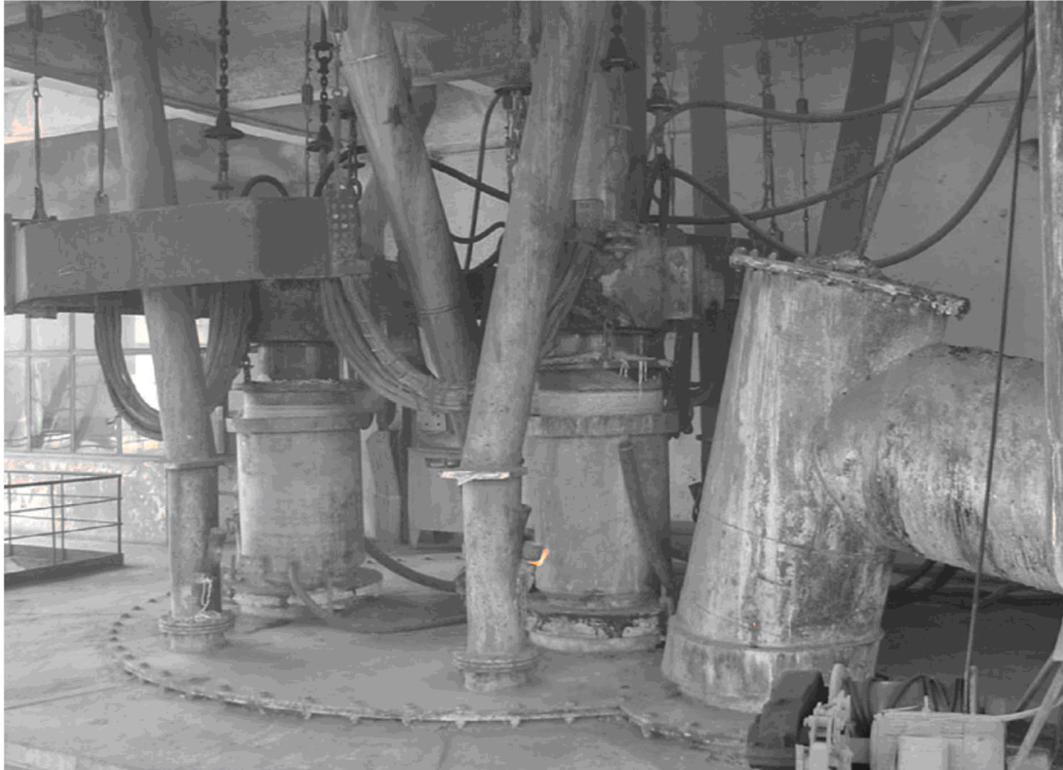
Kleiner elektrischer Ofen mit drei Elektroden (zwei sichtbar).
